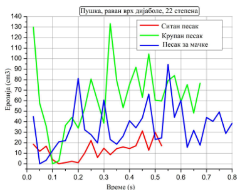
Слика 6.17 Преказ дијаграма акумулације ерозије гранулата у функцији времена приликом гађања из ваздушне пушке дијаболом са равним врхом и углом гађања од 22^\circ
