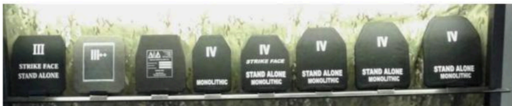
Слика 2.2 Различити нивои панцирне заштите према NIJ стандардима [11]
