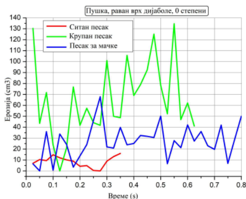
Слика 6.15 Приказ дијаграма акумулације ерозије гранулата у функцији времена приликом гађања из ваздушне пушке дијаболом са равним врхом и углом гађања од 0^\circ
