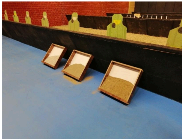
Слика 5.4. Препреке од грануларне материје – сопствена експериментална поставка Основни параметри реализованог експеримента приказани су у табели 5.3. Табела 5.3. Параметри експерименталног испитивања
