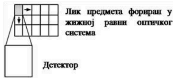
Слика 3.2. Принцип рада серијског система са јединичним детектором (према: Васиљевић Д. Оптички уређаји и оптоелектроника [77]).
