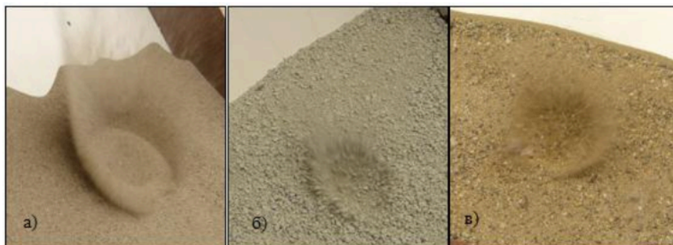
Слика 5.5 Снимак удара пројектила у различите врсте грануларне материје: а) ситан песак, б) песак за мачке, в) крупан песак (ауторска фотографија) – снимљено Panasonic DMC-FZ200, сопствена експериментална поставка
