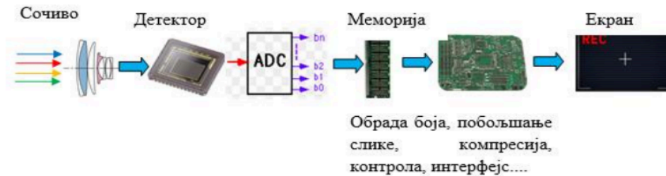
Слика 3.9. Структура савремених дигиталних ултрабрзих камера (измењено према: Редјими А. Просторно-временска калибрација система за анализу вишеканалних видео и аудио записа [81]).
